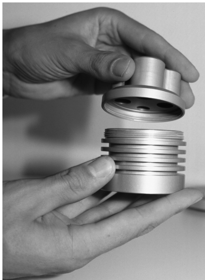
Рис. 2.2.4. Закрытие камеры крышкой для камеры.
