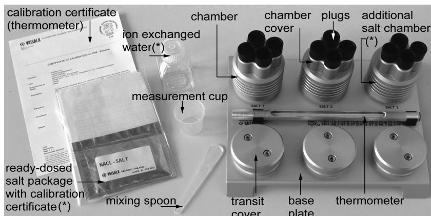
Рис. 1 Калибратор НМК15 с комплектующими (*).
