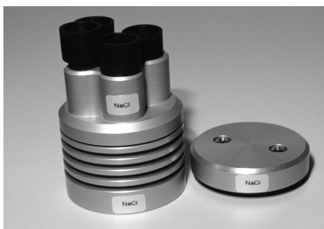
Рис. 2.2.5. Маркировка камер и крышек клейкой бумагой.
