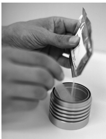
Рис. 2.2.3. Высыпание точной дозы соли в камеру, постоянно помешивая.
