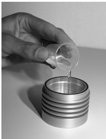
Рис. 2.2.2. Налейте точную дозу ионообменной воды в камеру; высушите измерительный стаканчик.
