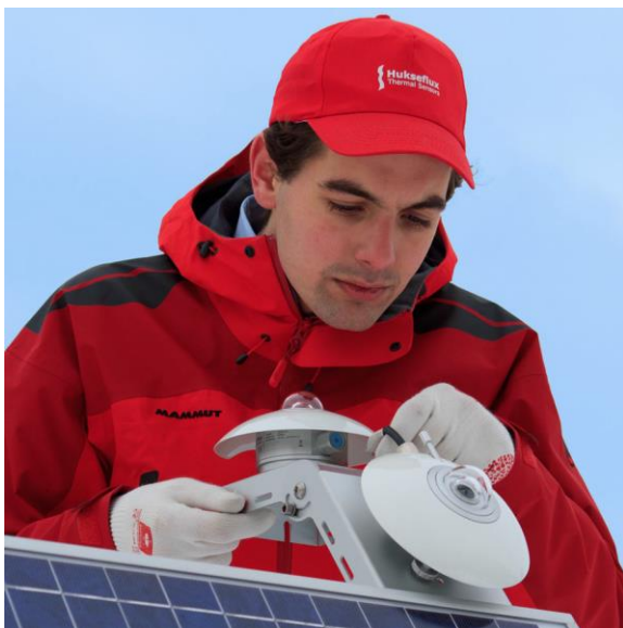
Рисунок 1. Пиранометр SR20 класса вторичный эталон
