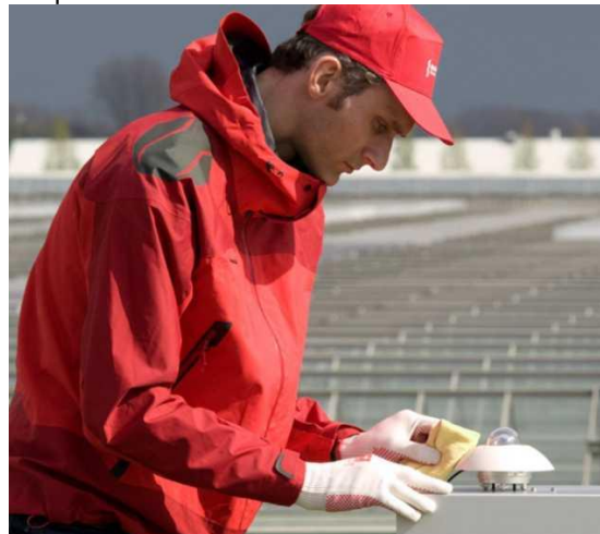
Рисунок 2. Пример использования: солнечный датчик используется для климат-контроля теплиц; пиргеометры также используются для этой цели.
