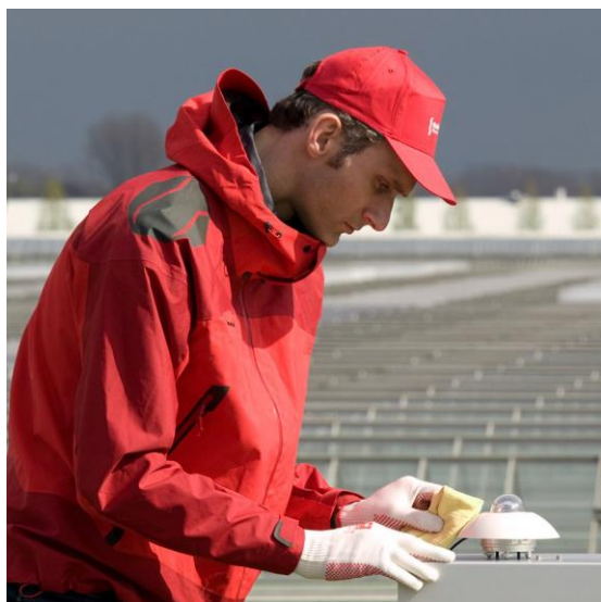
Рисунок 2 Использование пиранометра SR11 в теплицах
