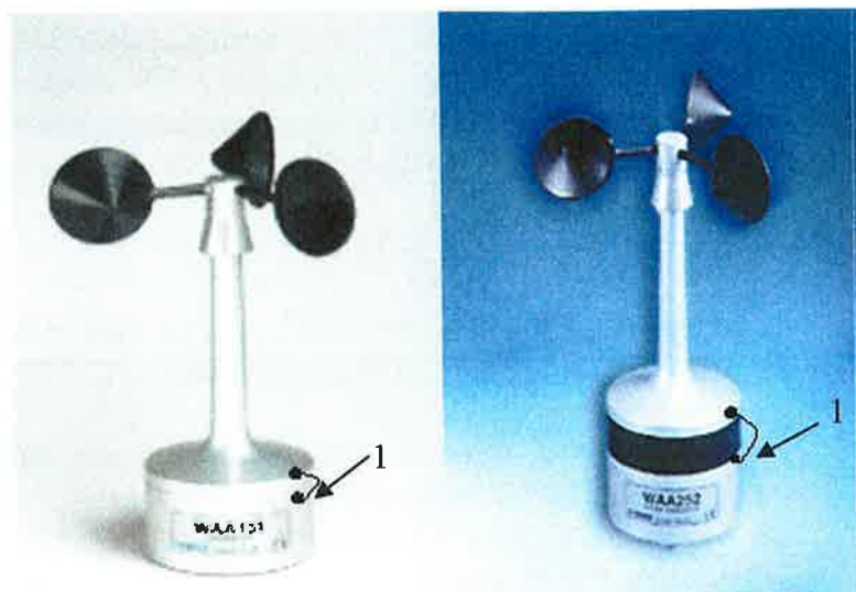
Рисунок 2. Схема пломбирования преобразователей WAA151/252. Пломбы – 1.
