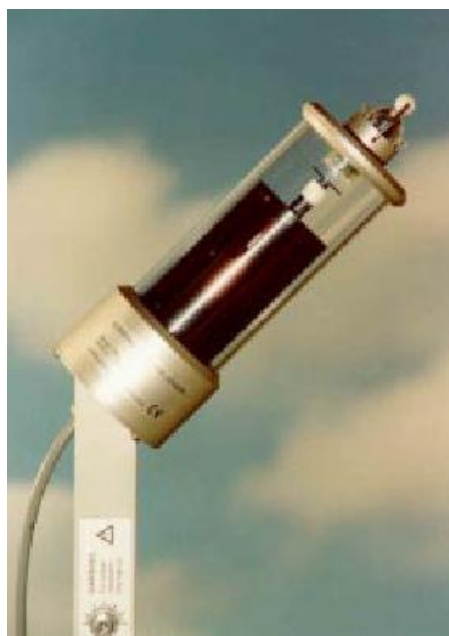
Рисунок 73 QSD102-M3 Датчик продолжительности солнечного сияния
